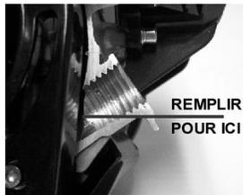
4. Tournez le bouchon du réservoir d'huile dans le sens inverse des aiguilles d'une montre et déposez-le. Le niveau d'huile doit se trouver au milieu du filetage dans la partie inférieure du trou de remplissage (voir ci-dessus).
